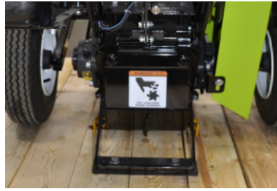
klappbarer Schutz mit einfachem Zugang zu den Frässternen
